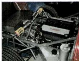
La HWM Targa BT01 reçoit un V8 5,7l en position centrale arrière. La voiture sera bientôt homologuée pour la route. (Photos RA)
